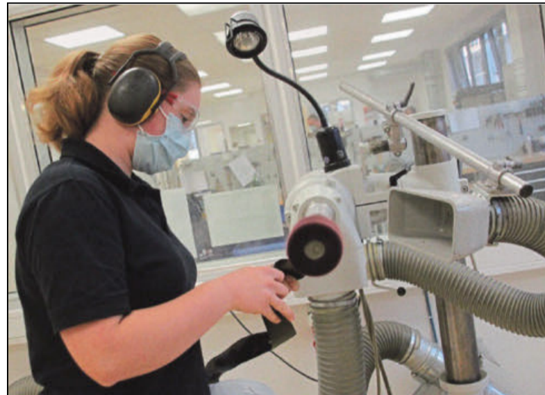
Arbeitsalltag für Rica Rüter: Mit der Trichterfräse werden rohe Kantanten an einer Karbonfederorthese bearbeitet.
